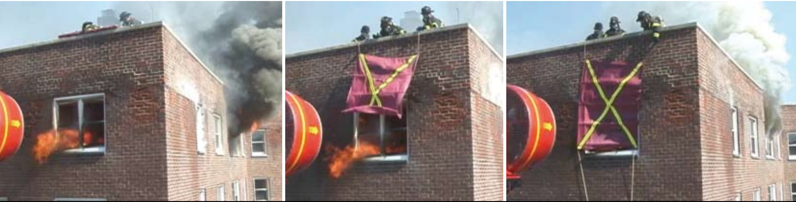
Einsatz eines Windblockers (Wind Shield Device) zur Reduzierung des Luftstroms bei einem Brandversuch des NIST
