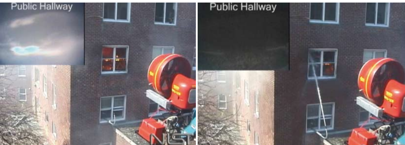
Einsatz einer Löschlanze auf Höhe des Geschosses unterhalb des Brandraumes: Die kleinen Bilder jeweils oben am linken Bildrand zeigen die Aufnahme einer Infrarotkamera, die direkt vor dem Brandraum aufgestellt war. Deutlich erkennbar ist der starke Temperaturabfall.
