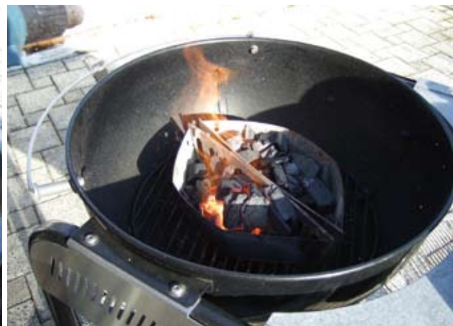
Ventilieren bedeutet nicht immer Kühlen! Glut kann durch Einblasen von frischer Luft (wie hier bei einem einfachen Versuch mit einem Föhn als Luftströmungsquelle) angefacht werden. Hierdurch erhöht sich die Energiefreisetzung.
