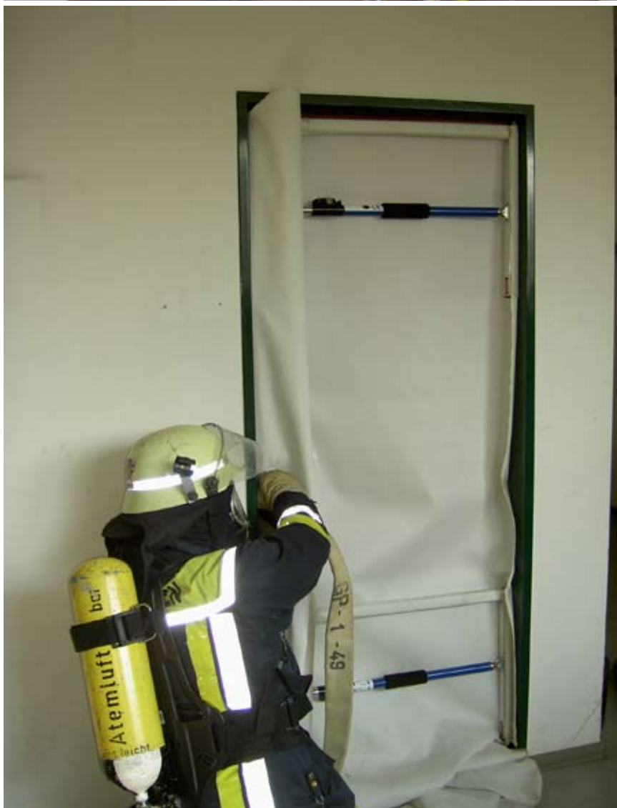
oben: Einsatz eines Mobilen Rauchverschlusses zum Verschluss der oberen Türhälfte und zum Einsatz eines Belüftungsgerätes unten: Verschluss einer Türöffnung mit zwei Mobilern Rauchverschlüssen zum Blockieren eines Luftstroms innerhalb eines Gebäudes bei gleichzeitig möglicher Wasserabgabe in den Brandbereich
