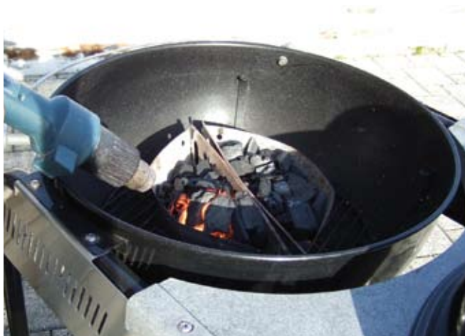
Ventilieren bedeutet nicht immer Kühlen! Glut kann durch Einblasen von frischer Luft (wie hier bei einem einfachen Versuch mit einem Föhn als Luftströmungsquelle) angefacht werden. Hierdurch erhöht sich die Energiefreisetzung.
